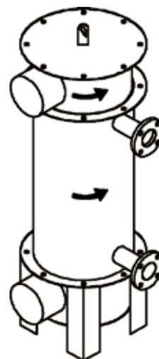
Cappe fumo ed attacchi idraulici possono essere ruotati di 360°, con scatti di 22,5° tra loro, per adattare recuperatori ad ogni tipo d'impianto.
