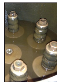
Candela magnetica con impurità captate
