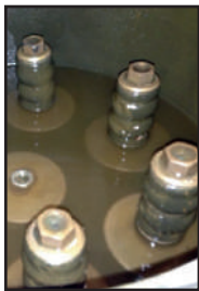
Candela magnetica con impurità captate
